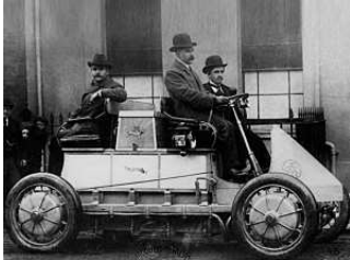
Lohner-Porsche Elektromobil mit Radnabenmotoren (1899)
