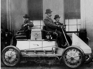
Lohner-Porsche Elektromobil mit Radnabenmotoren (1899)
